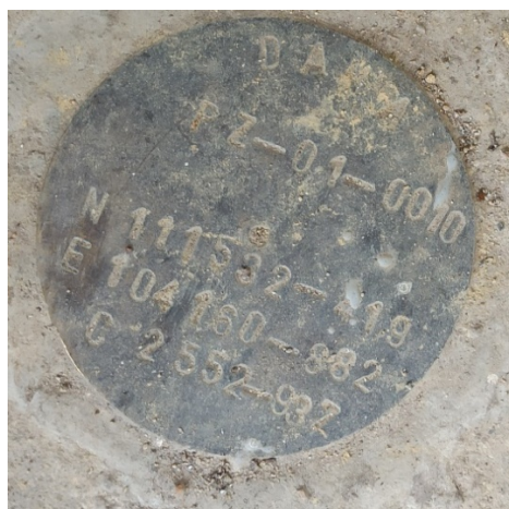
Foto 6. Placa de georreferenciación y nivelación del pozo pz-01-0010
